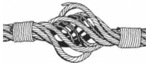
Diámetro parcialmente reducido de filamentos y cables
